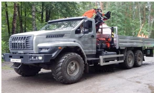
Рисунок 1 - Урал Next с краново-манипуляторным устройством
