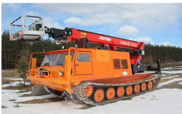
Рисунок 3 - СГТ-31 с краново-манипуляторным устройством
