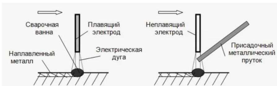
Рисунок 2 - Схема наплавки плавящимся и неплавящимся электродом
