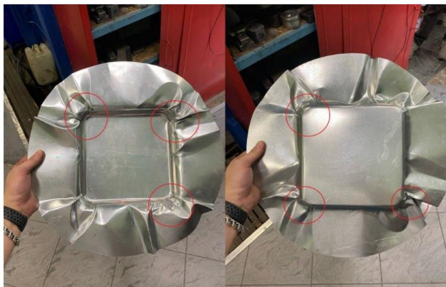
Рисунок 13 - Фото полученной заготовки в процессе вытяжки на прессе ПО54
