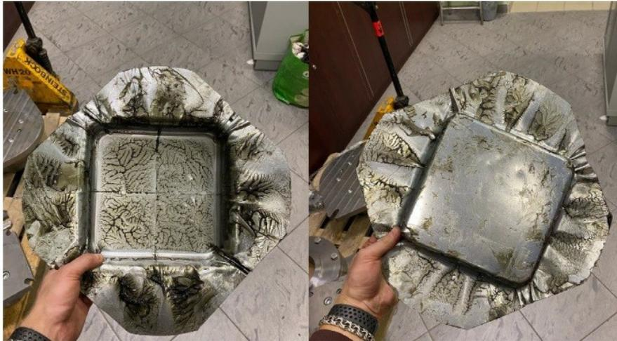
Рисунок 18 - Фото вытянутой коробки из заготовки с обрезными краями
