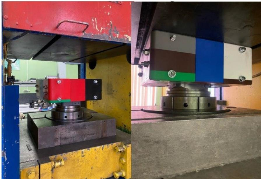
Рисунок 12 - Фото вытяжки при неподвижном пуансоне
