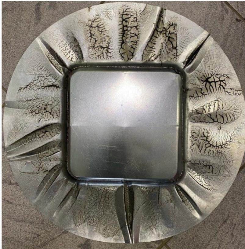
Рисунок 17 - Результат вытяжки с прижимом
