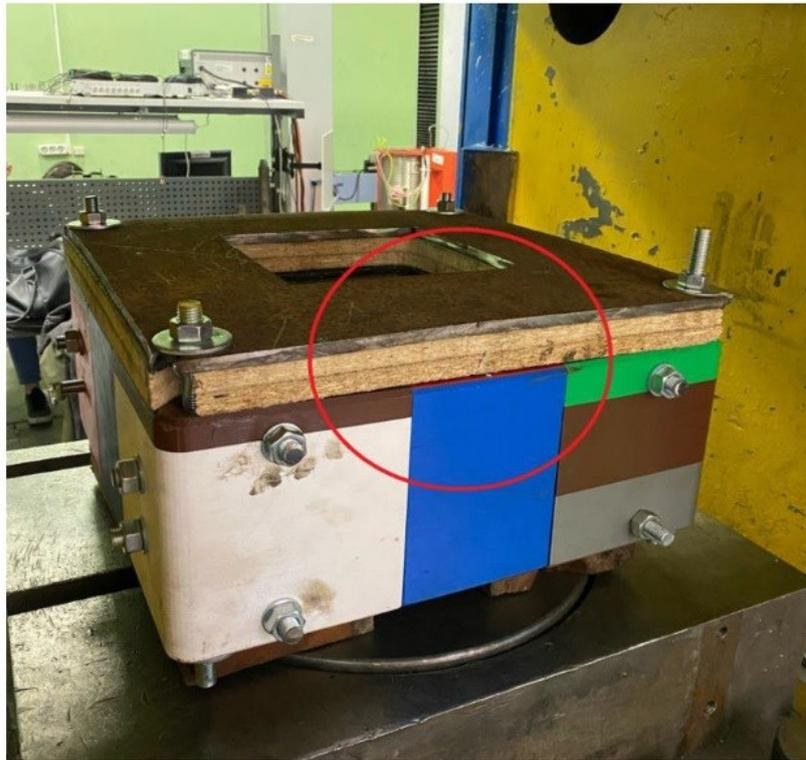
Рисунок 16 - Сборка с металлическим прижимом 12 мм
