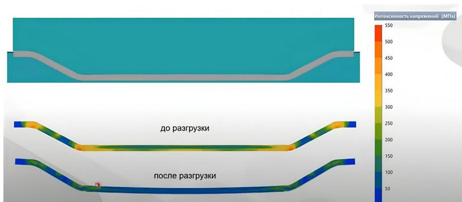
Рисунок 6 - Наглядное изображение прогиба дна заготовки, полученное в программе QForm
