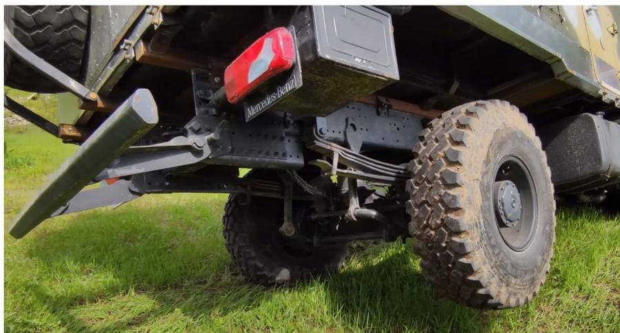
Рисунок 2 - Ход задней подвески Mercedes-Benz Zetros
