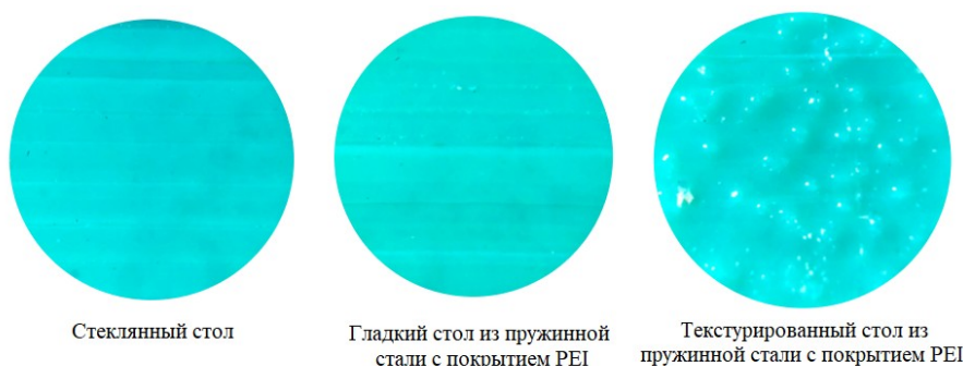
Рисунок 10 - Поверхность детали, напечатанной на каждом типе стола
