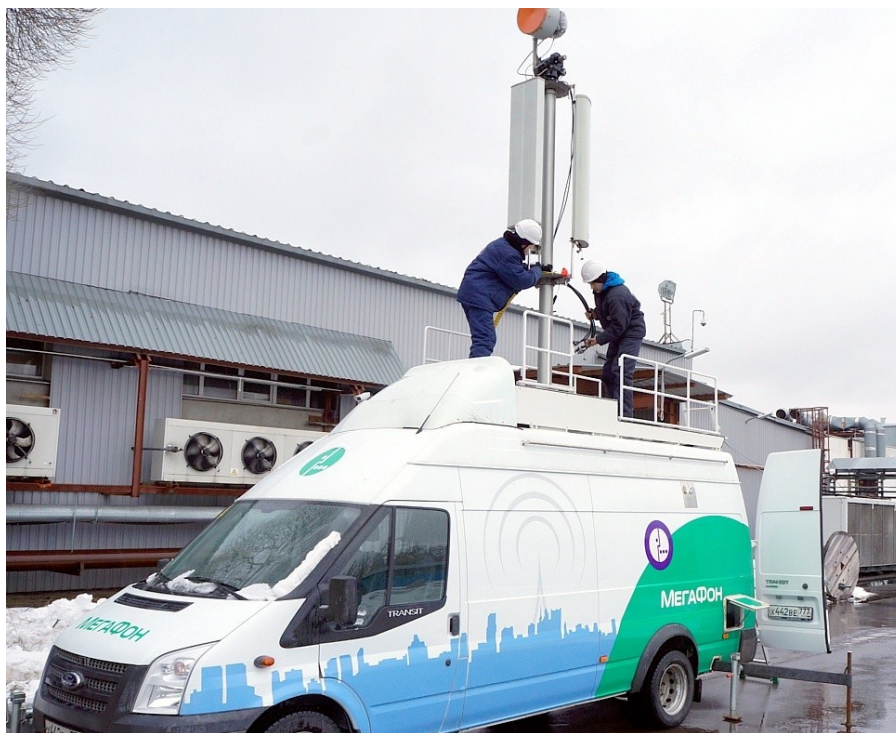
Рисунок 3 - Передвижная базовая станция на платформе Ford Transit DOI: https://doi.org/10.18454/ENGIN.2023.1.3.3
