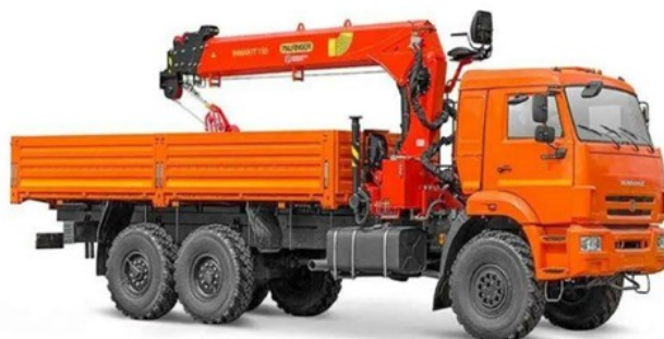
Рисунок 2 - КАМАЗ - 43118 с краново-манипуляторным устройством DOI: https://doi.org/10.18454/ENGIN.2023.1.1.2
