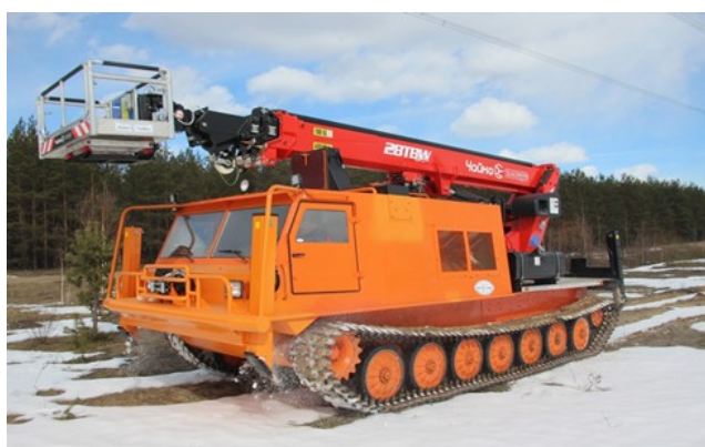
Рисунок 3 - СГТ-31 с краново-манипуляторным устройством DOI: https://doi.org/10.18454/ENGIN.2023.1.1.3
